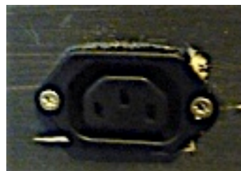
Figure 9 : Exemple de prise IEC mâle et femelle qui accueilleront le câble venant de la prise sur l'arrière du module.
