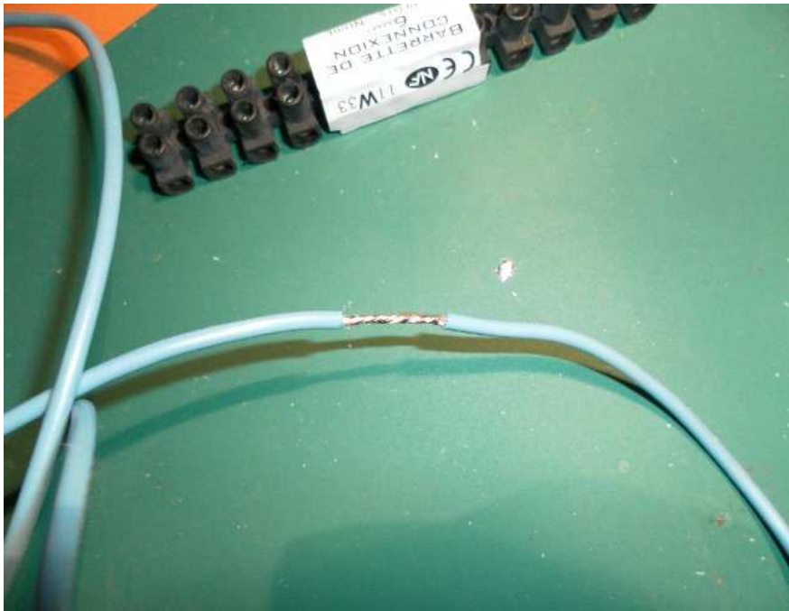
Figure 32: la partie dénudée est étamée pour éviter l'écrasement par les vis
