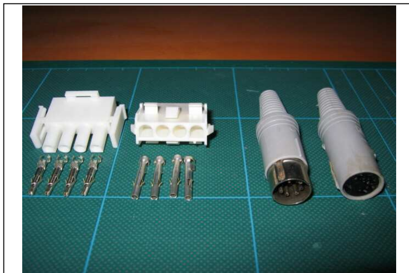
Figure 3: connecteurs HE15 (4 broches) et connecteurs DIN (5 broches)
